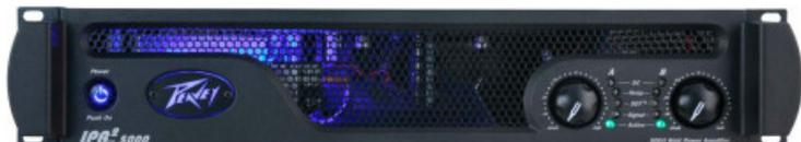
IPR 2 5000 890+890 Watt RMS-8 Ohm, 1.510+1.510 Watt RMS-4 Ohm. Finale di potenza in classe D, Crossover 24 dB/ottava di tipo Linkwitz-Riley, circuito di rilevazione di distorsione DDT per mantenere l'integrità sonora in ogni situazione. In Combi (XLR/Jack)-Out Speakon. Dimensioni 89x48x27- Peso ca. 6,2 kg.
