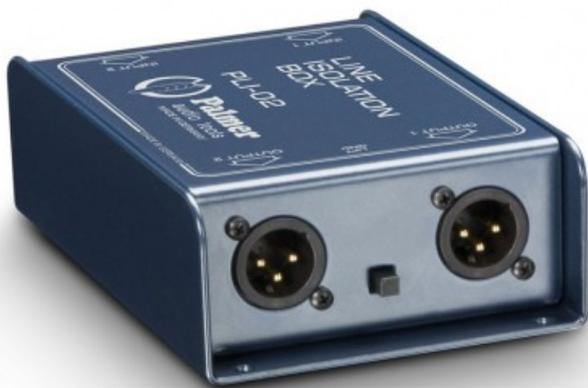
Separatore di linea a due canali (Line Isolator). Ingresso per prese combinate Neutrik (presa XLR e jack) e uscita XLR. PLI02 dispone inoltre di un interruttore Ground-Lift. Perfettamente indicato per evitare i ritorni di terra. Possibilità di conversione asimmetrica in simmetrica. La versione da 600 Ohm può gestire livelli fino a +20dBu.
