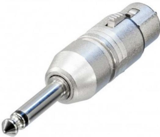
Connettore XLR femmina a 3 poli - Connettore mono da 1/4 (contatto punta e manica) Cablaggio secondo la norma IEC 268-12:Pin 2: segnale Pin 1 e 3: messa a terra
