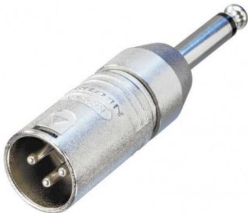
Connettore XLR maschio a 3 poli - Spina mono da 1/4 (contatto punta, manicotto) Cablaggio secondo IEC 268-12:Pin 2: segnale Pin 1 e 3: messa a terra
