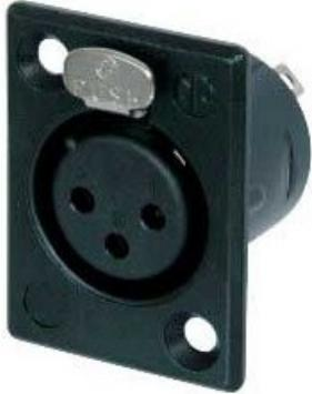
Connettore femmina a 3 pin, contatti a saldare, alloggiamento in metallo nero, contatti placcati in oro. Il più piccolo connettore per montaggio a pannello in metallo di tipo tradizionale disponibile sul mercato, con ampie coppe di saldatura per facilitare il cablaggio.
