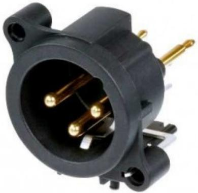
Presa XLR maschio a 3 poli, messa a terra: contatto di terra separato per l'alloggiamento del connettore e il pannello frontale, montaggio verticale su scheda. Connettore da pannello XLR per montaggio su PCB con corpo rotondo in plastica. Questi connettori hanno le dimensioni più ridotte e la più alta densità di confezionamento (23 mm da centro a centro). Contatti placcati in oro duro con aree di contatto lucidate. Componente riconosciuto UL.
