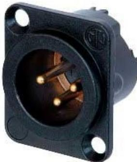
Presa maschio a 3 poli, con terminali a saldare, alloggiamento in metallo nero, contatti placcati oro. La serie DLX è caratterizzata da un alloggiamento metallico compatto con un ingegnoso contatto di terra duplex, che offre un'eccellente schermatura e protezione RF. È la combinazione ideale per il collegamento con il connettore Neutrik EMC XLR.
