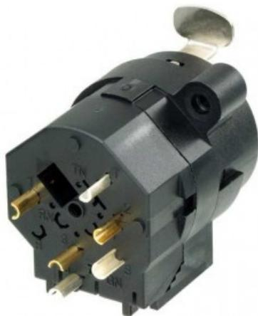
Presa XLR femmina a 3 poli con connettore mono da 1/4 senza contatto di commutazione, con terminali a saldare per la terminazione del cavo. Connettore a telaio ibrido XLR / jack che combina una presa XLR a 3 poli e un jack da 1/4 .
