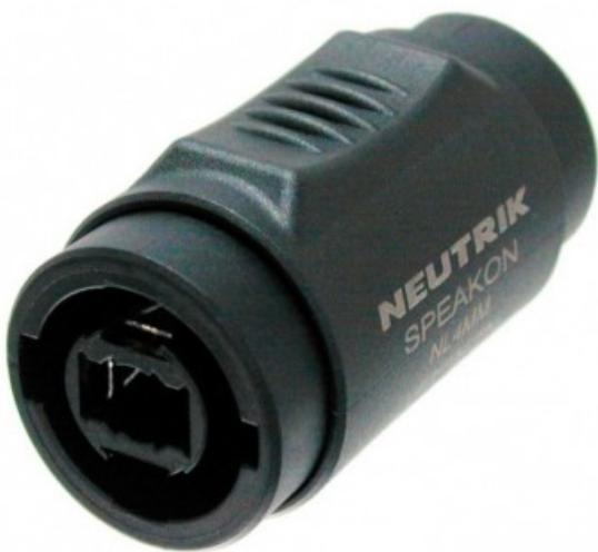
Adattatore speakON a 4 poli con bloccaggio. Accoppia due connettori NL2/4F\* per estendere il cavo. Cambia il genere in maschio quando viene bloccato in modo permanente nel cavo. Caratterizzato da una connessione sicura e permanente a un connettore del cavo speakON grazie a un secondo blocco. Può essere fissato in modo permanente a un NL2/4F\*.
