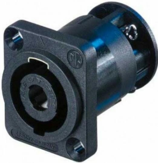
Connettore a telaio a 4 pin, flangia di dimensione D di colore nero, fori svasati, terminazione a vite. I connettori speakON per montaggio a pannello sono i connettori a telaio standard per le interconnessioni tra diffusori e amplificatori. Sono dotati di un esclusivo sistema di bloccaggio in metallo che stabilisce il contatto solo quando è completamente bloccato. Le prese speakON sono robuste, versatili e facili da terminare.
