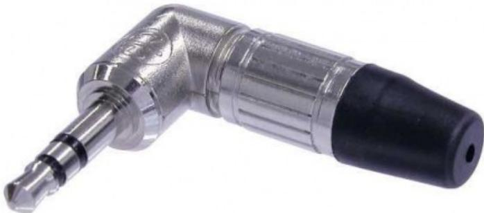
Connettore audio a 3 poli da 3,5 mm, terminato a saldare, scarico della trazione a mandrino, ghiera, corpo in nichel, contatti in nichel. L'unico connettore maschio da 3,5 mm con corpo in metallo e angolo retto, con scarico della trazione a mandrino per un serraggio sicuro del cavo. Accetta cavi da 2,0 a 4,5 mm.
