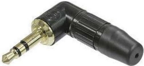
Connettore audio a 3 poli da 3,5 mm, terminazione a saldare, scarico della trazione con mandrino, ghiera, corpo nero, contatti placcati oro. L'unico connettore jack da 3,5 mm ad angolo retto con corpo in metallo e scarico della trazione con mandrino per una ritenzione sicura del cavo. Accetta cavi da 2,0 a 4,5 mm.
