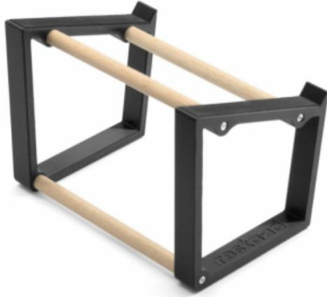
Stampa 3D di alta qualità Ergonomico: inclinazione di 20 gradi Rialza di 80 mm lo strumento dal piano di appoggio Affidabile: realizzato in PLA, plastica rigida e compostabile Pratico: semplice da assemblare Utile: mantiene ordinata l'area di lavoro Stabile: dotato di gomma antiscivolo alla base Dimensioni complessive: 145 x 115 mm x 123 mm
