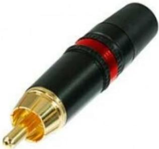
Connettore fono, custodia nera, contatti placcati in oro, guaina in gomma antitorsione, scarico della trazione a mandrino (codice colore rosso, diametro esterno del cavo 3,5 - 6,1 mm) Confezionato singolarmente in un sacchetto
