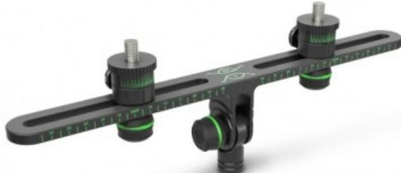
**Materiale**Alluminio**Colore**Nero**Larghezza di regolazione**60 - 290 mm**Collegamento filettato**3/8 "**Spessore materiale**8 mm**Angolo di inclinazione**-90 - +90 ° **Lunghezza**330 mm**Peso**0,719 kg
