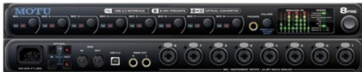
Interfaccia audio a 24 bit e 96 kHz. Disponiamo di 8 preamplificatori microfonici o strumentali con alimentazione phantom a 48 V e connettori combo XLR/jack, 8 canali ADAT ottici digitali I/O. Porta MIDI inout. Espandi il tuo sistema collegando ulteriori unit 8pre ad altre interfacce MOTU Firewire o di qualsiasi marca e sistema di connessione dotate di ingresso ADAT. Utilizza il software Cue Mix per mixare fino a 16 ingressi e creare fino a 4 mix diversi da inviare alle uscite.
