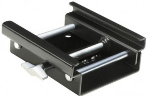
**Materiale** acciaio **Superficie** Rivestimento a polvere nero **Colore** Nero **Adatto per la larghezza della staffa** 50 - 100 mm **Filettature di montaggio** M10 **Filettature di montaggio** M14 **Max. capacità di carico** 150 kg **Lunghezza** 170 mm **Larghezza** 150 mm **Altezza** 57 mm **Peso** 1,3 kg **Altre caratteristiche** Certificato TÜV
