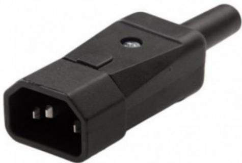
Ricablabile, per linea di alimentazione H05RRR-F o H05VVV-F da 3G0,75 mm<sup>2</sup> a 3G1,0 mm<sup>2</sup>, per lunghezze superiori a 2 metri minimo 3G1,0 mm<sup>2</sup>
