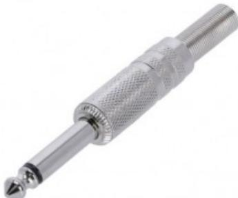
La nostra vasta selezione di spine diverse include questa spina jack da 6,3 mm con contatti sbilanciati. Il cavo è collegato alla spina tramite saldatura e lo scarico della trazione metallica dà all'intera struttura la stabilità necessaria all'estremità.
