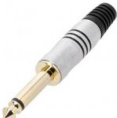
La nostra ampia selezione di spine diverse comprende questa spina jack da 6,3 mm con contatti sbilanciati. Il cavo è collegato alla spina mediante saldatura e il dispositivo antistrappo metallico conferisce all'intera struttura la necessaria stabilità all'estremità.
