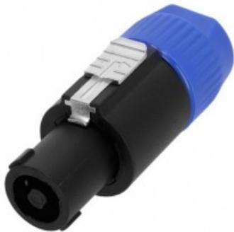
Lo standard per collegare gli altoparlanti. Un vero classico quando si tratta di connettori per altoparlanti che devono essere compatibili con le prese speakON. Avvitabile, adatto a cavi con un diametro da 6 a 10 mm
