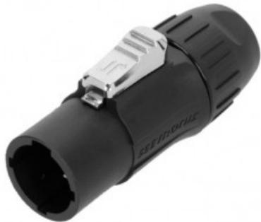
Il connettore di alimentazione a 3 poli sostituisce i connettori IEC quando è necessaria una soluzione di bloccaggio molto robusta. Compatibile con tutte le comuni prese powerCON TRUE1-TOP, il nostro 4 STAR C PM TCON è una scelta robusta e valida per l'alimentazione di apparecchiature con connessione di potenza bloccante. Capacità di carico fino a 16 A / 250 V AC. Protetto IP65 quando è accoppiato. Con componenti riconosciuti UL.
