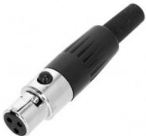
Connettore di alta qualità e durata della nostra serie 4 Star. I mini XLR sono utilizzati soprattutto per i sistemi wireless. Questo piccolo ma robusto tappo è realizzato in zinco fuso ed è dotato di un gommino in plastica e di un meccanismo di bloccaggio.
