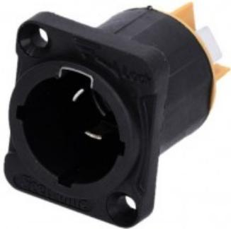
La presa di rete a 3 poli sostituisce le spine per apparecchi freddi quando è necessaria una soluzione di chiusura molto robusta. Compatibile con tutte le più comuni spine powerCON TRUE1-TOP, la nostra presa da incasso 4 STAR è una scelta robusta e valida per l'alimentazione di dispositivi con connessione di potenza bloccata. Capacità di carico fino a 16 A / 250 V CA. Protezione IP65 quando è accoppiato. Con componenti riconosciuti UL.
